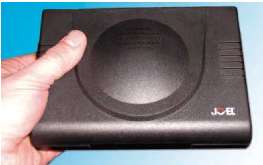
Vastaanottimessa ja kamerassa ei ole ulkoisia antennia, mikä asettaa lisävaatimuksia kameran sekä vastaanottimen sijoittelulle.
